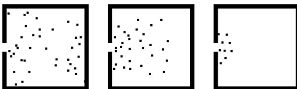
Пример моделирования процесса эвакуации из одной комнаты.
