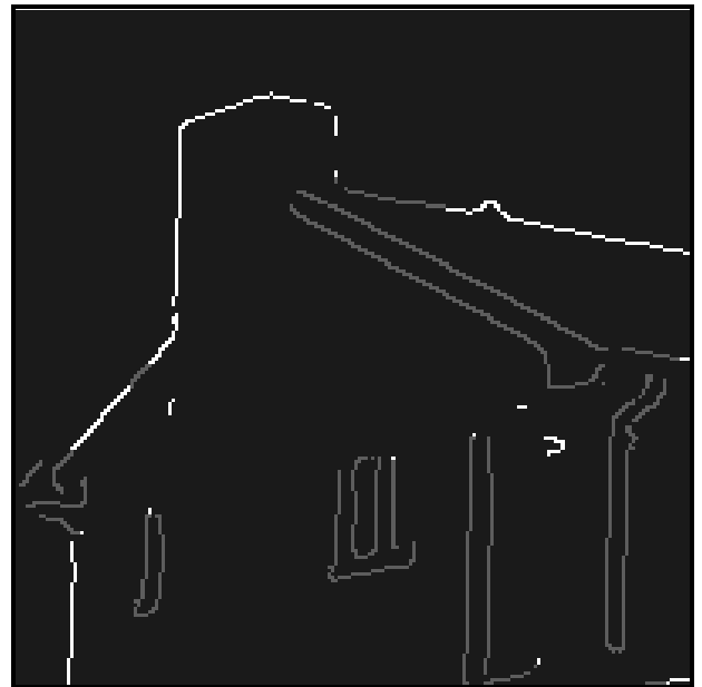
г) Результат выделения базовых контуров на изображении. Белым цветом обозначены базовые контуры, серым — контуры, прошедшие условие маскирования (6.2.1), но не являющиеся базовыми.
