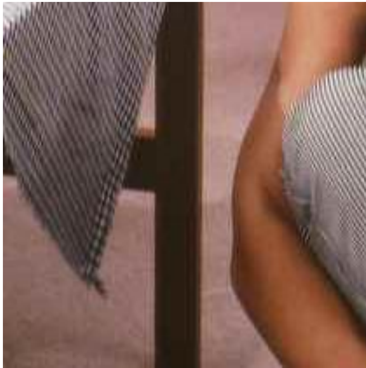
Рисунок 7 — Фрагмент входного изображения для программы с эффектом Гиббса, полученного при сжатии JPEG.
