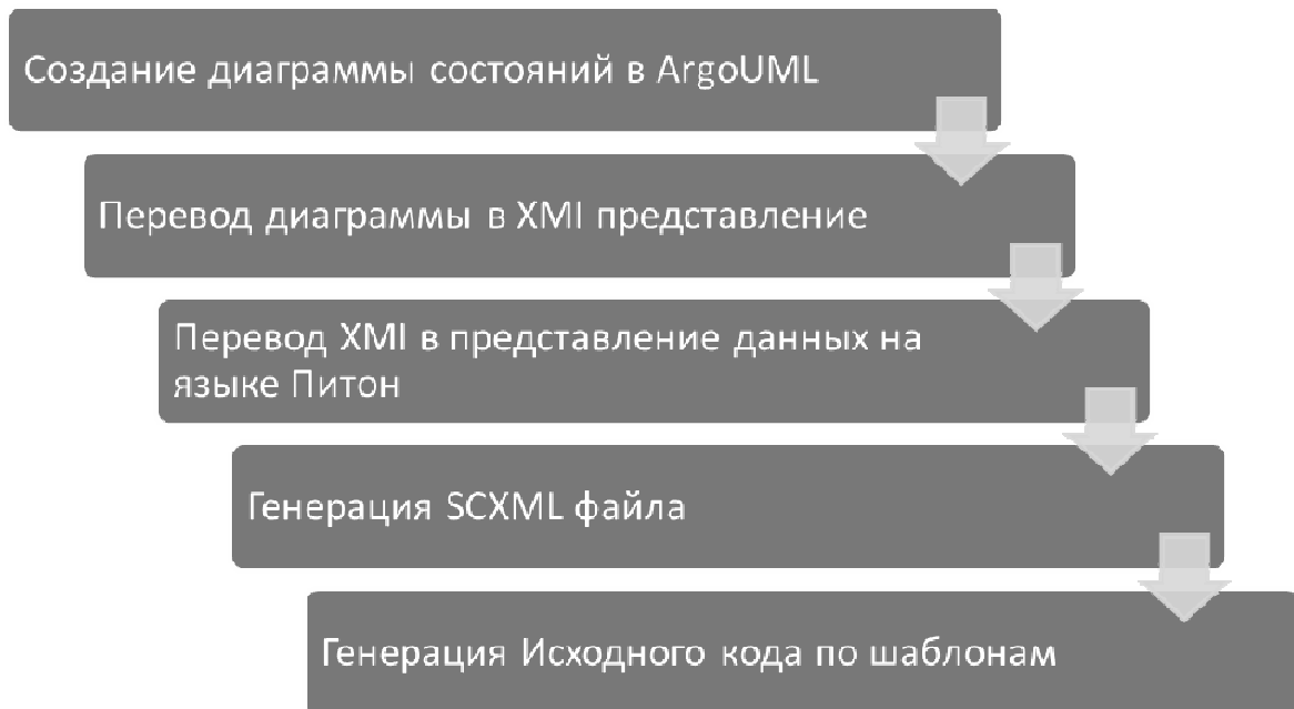
Рисунок 56 - Полная схема генерации исходного кода модели.
