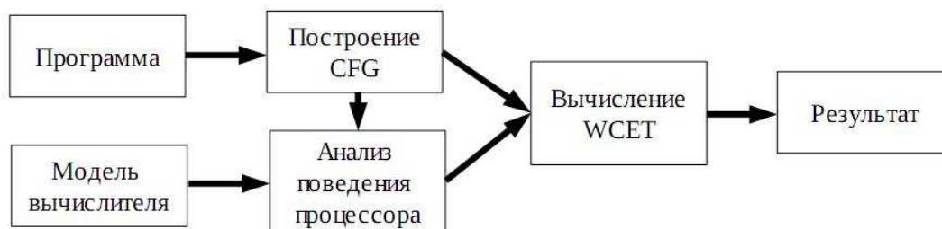
Рисунок 19 - Типичная схема анализа программы статическим методом
