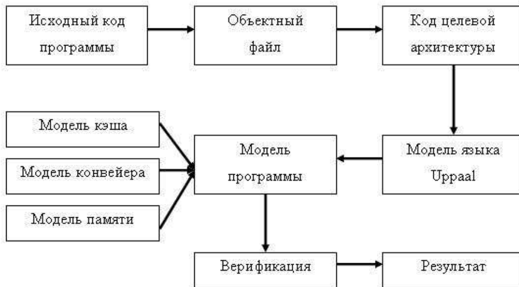
Рисунок 23 - Схема работы анализатора
