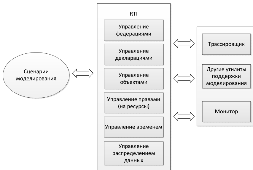
Рисунок 9 - Функциональное представление моделирования на основе HLA RTI
