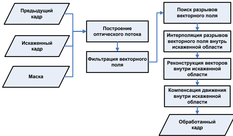
Рис. 4. Схема метода временного маскирования на основе анализа оптического потока
