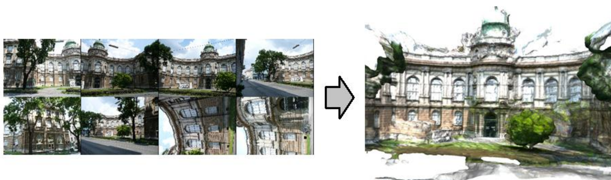
Рисунок 1. Пример изображений и построенной по ним трехмерной модели
